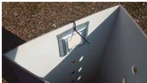
Figura 112. Detall de la col·locació del dispensador de la trampa.
